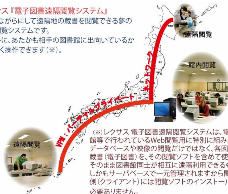
図3 シンクライアント方式 CD/DVD サーバと VPN を組み合わせた遠隔閲覧システム
